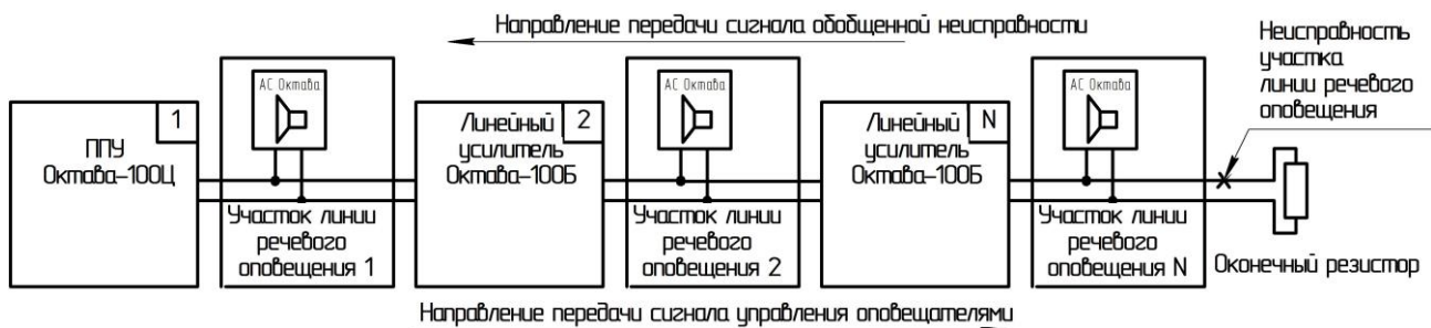
Рисунок 3.1 - Схема передачи сигнала «Неисправность» по линии речевого оповещения
