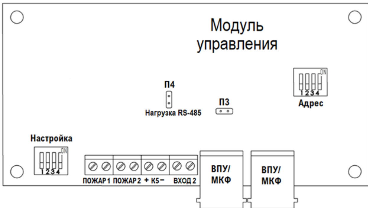
Рисунок 2.2 - Органы управления и регулировки, расположенные под защитной панелью модуля управления ППУ
